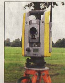
Der Theodolit ist ein Winkelmessgerät.
